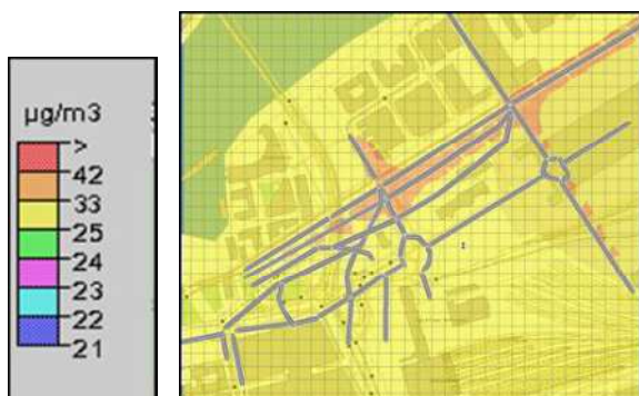
Figur 6-2 98-percentil av dygnsmedelvärdet av NO 2 -halter på Centralstation beräknades med hjälp av Simair-korsning år 2030; med Västlänken.
