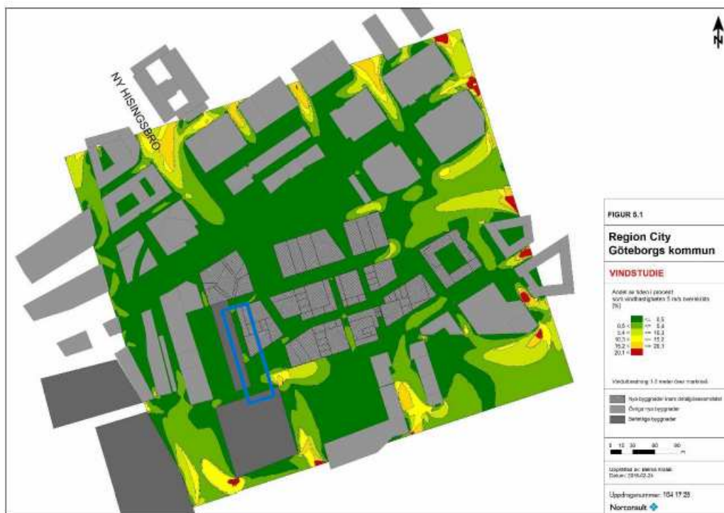
Figur 5-1 Vindhastigheter över 5m/s förekommer mindre än 0,5 % i det mörkgröna området (lämpligt för längre uppehåll) och mer än 20 % i det röda området (olämpligt även för kortare uppehåll). (Norconsult, 2016)
